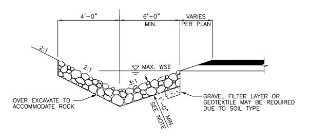
ROCK-LINED SHOULDER DITCH IN CUT SECTION
