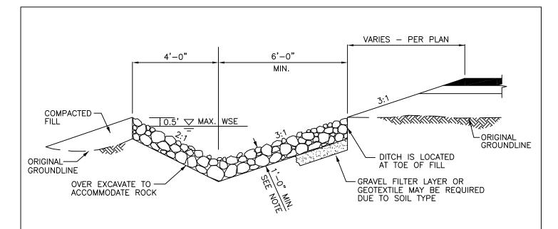
ROCK-LINED SHOULDER DITCH IN FILL SECTION
