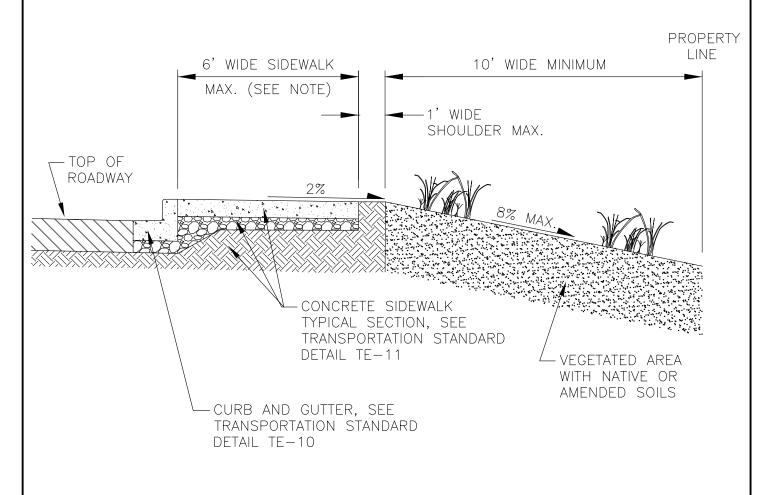
NOTE LONGITUDINAL SLOPE SHALL BE 10% MAXIMUM
