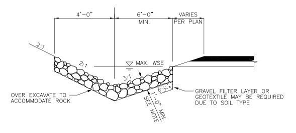
ROCK-LINED SHOULDER DITCH IN CUT SECTION
