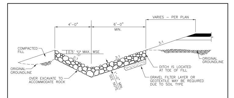
ROCK-LINED SHOULDER DITCH IN FILL SECTION
