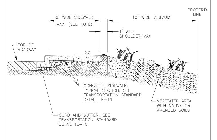
NOTE LONGITUDINAL SLOPE SHALL BE 10% MAXIMUM
