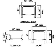
MANHOLE DROP RUNG STEP
